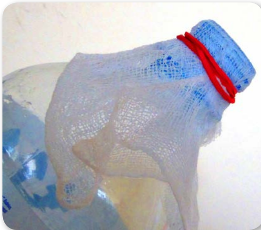
1.4 pav. Butelio kaklelis užrištas medicinine marle. Nors ji labai reta, tačiau, apvertus butelį, vanduo iš jo neišbėga
