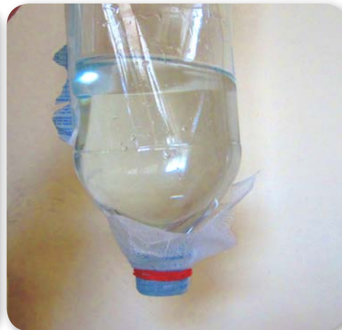
1.4 pav. Butelio kaklelis užrištas medicinine marle. Nors ji labai reta, tačiau, apvertus butelį, vanduo iš jo neišbėga
