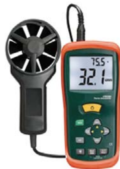
Anemometras. Matavimo ribos: 0,4–30,00 m/s
