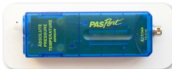
3.1 pav. Slėgio jutiklis PS-2113A
